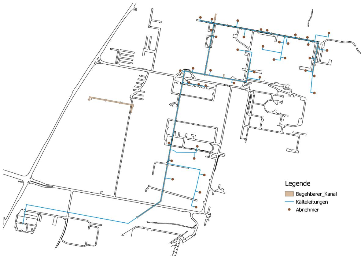
Abbildung 47: Leitungsverlauf und Abnehmer eines möglichen Kältenetzes am „Campus Ost“. Das Kältenetz beginnt an der Energiezentrale im Südwesten und verläuft entlang der Nord-Süd-Achse durch den begehbaren Kanal unter den Gebäuden Mathematik-Informatik und Maschinenwesen. Im Bereich Chemie und Physik ist das Netz zum Anschluss vieler kleinerer Verbraucher deutlich verzweigt.
