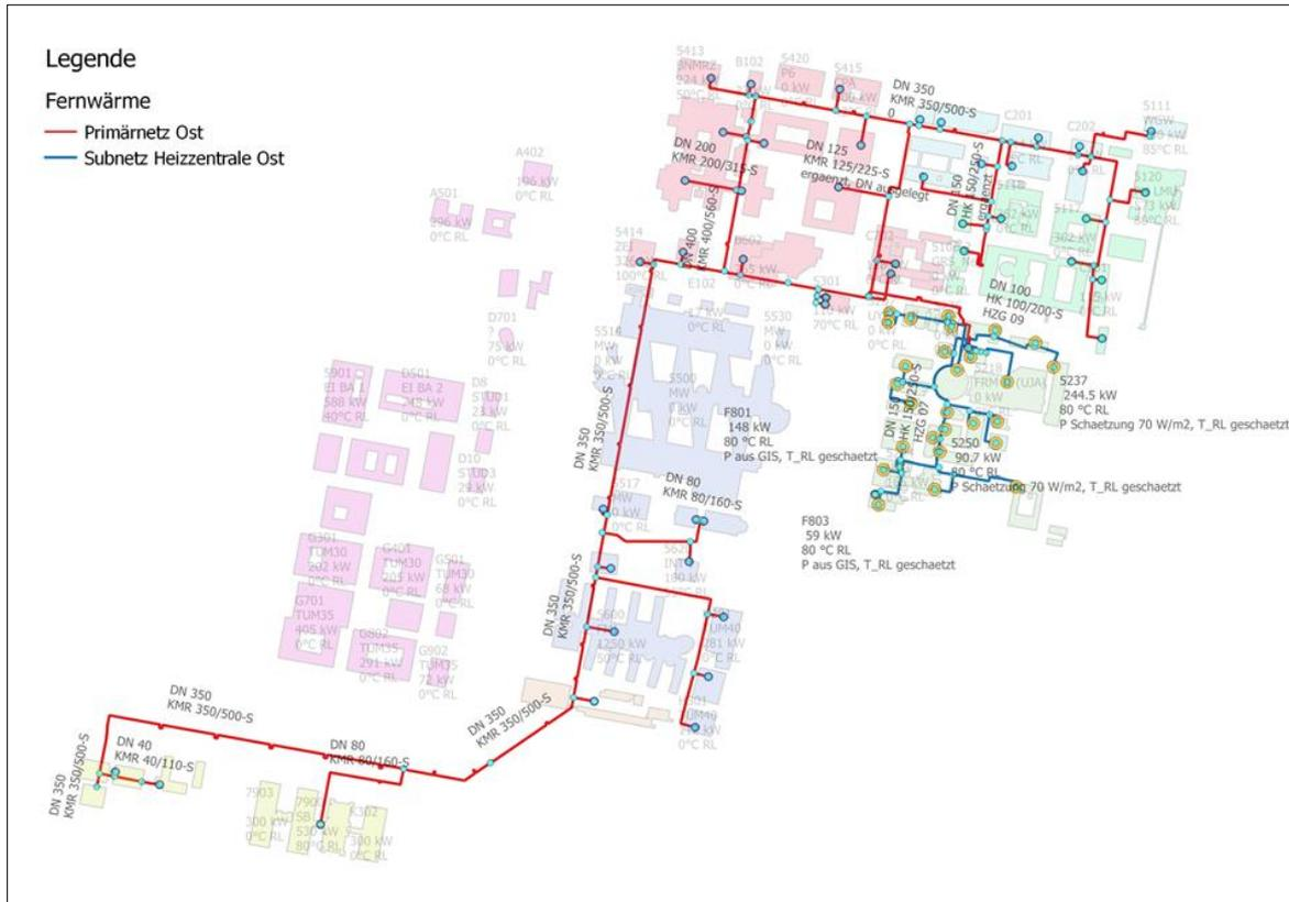
Abbildung 38: Möglicher Endausbau des Fernwärme-Stammnetzes am Campus Garching im GIS. Aus Gründen der Übersichtlichkeit ist nur der Vorlauf dargestellt.
