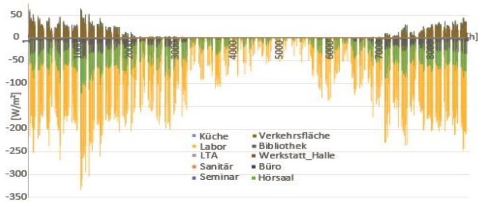
Abbildung 7: Wärmelastunterschiede der einzelnen Nutzungseinheiten zur Nutzungseinheit „Büro“ im Jahresverlauf innerhalb der Baualterklasse GEG
