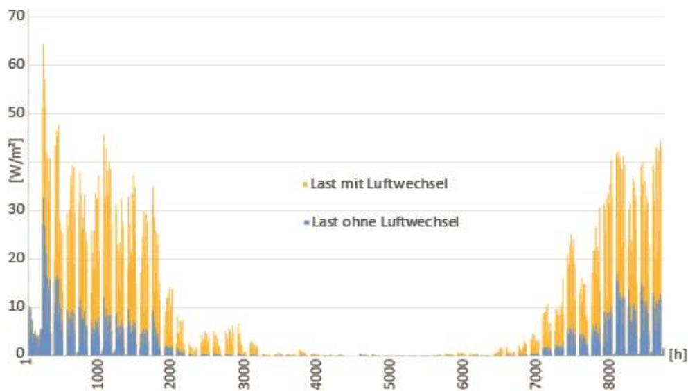
Abbildung 10: Durchschnittlicher Wärmelastbedarf der Nutzungseinheit Büro in der Baualterungsklasse GEG im Chemiegebäude mit und ohne Lüftungswärmeverluste
