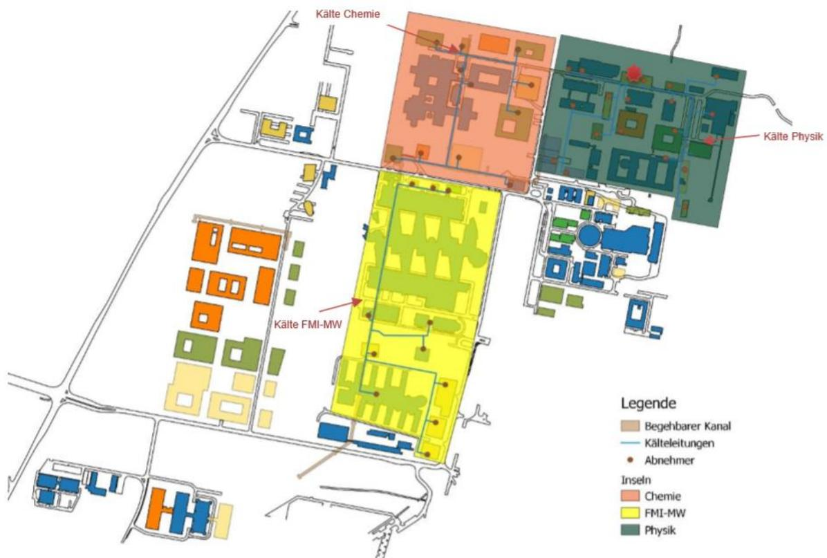
Abbildung 48: Zuordnung der Abnehmer zu den Versorgungsgebieten in der Variante mit semi-zentraler Versorgung. Weiterhin sind die Standorte der Kältezentralen und der Leitungsverlauf dargestellt.
