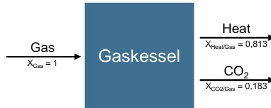
Abbildung 70: Beispielhafter Energieumwandlungsprozess der installierten Gaskessel
