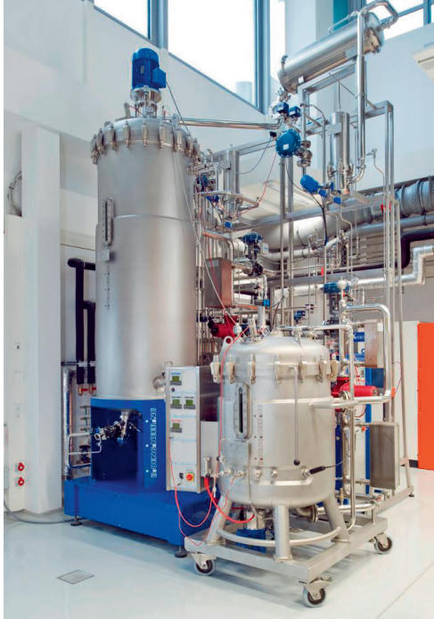
› PILOTANLAGE ZUR HERSTELLUNG VON BIOPRODUKTEN IM TUM-TECHNIKUM FÜR WEISSE BIOTECHNOLOGIE IM M3-MASSSTAB
